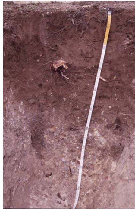
Figura 62. Perfil 30 (Retuerta, Burgos): Ae;A;Bwk;C. Kastanozem háplico (esquelético, crómico) sobre conglomerados calizos paleógenos. Precipitación anual: 628 mm. Pendiente: 20%.
