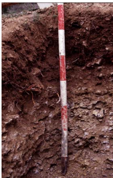
Figura 57. Perfil 64 (Abejar, Soria): A;Bw;Cgk. Calcisol hipercálcico (esquelético) sobre calizas grises cretácicas de grano medio. Precipitación anual: 822 mm. Pendiente: 20%.
