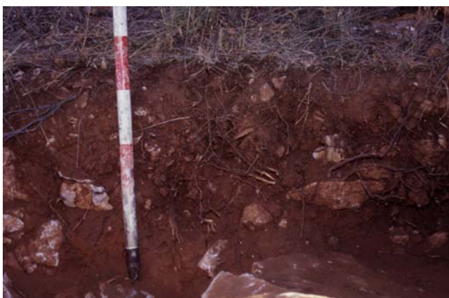
Figura 52. Perfil 51 (Araúz de Miel, Burgos): A/C;R. Regosol léptico (calcárico, esquelético, húmico) sobre calizas grises cretácicas de grano medio-grueso. Precipitación anual: 781 mm. Pendiente: 26%.
