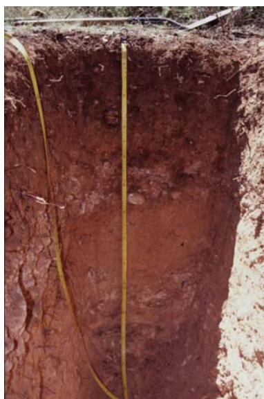
Figura 60. Perfil 56 (Hoz de Arriba, Soria): Ad;Bt;C;2C1;2C2. Calcisol hipercálcico sobre conglomerados calizos y arcillas miocenas. Precipitación anual: 692 mm. Pendiente: 7%. Suelo compuesto.
